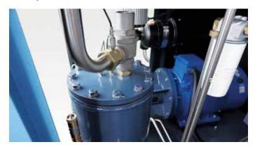
• Компрессоры серии MD динамически сбалансированы для обеспечения максимально безопасной и стабильной работы. Воздушный и масляный контур исполненные в металле, обеспечивают надежную работу в условиях перепада рабочих температур воздуха и масла. Такая конструкция более устойчива как к внешним механическим воздействиям, так и к внутренним (высокое давление).
