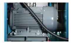
Компрессоры серии SB оснащены современными двигателями со степенью защиты IP54/F.
