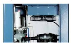
Работа двигателя вентилятора охлаждения теплообменника не зависит от работы основного двигателя.
