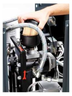
Компрессоры серии LB оснащены высокопроизводительными воздушными фильтрами в дополнительном корпусе (для повышенной защиты от пыли и крупных частиц в воздухе).
