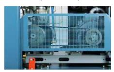
Ременной привод – достаточно простое и недорогое решение, обеспечивающее передачу крутящего момента.
