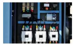
Штатно установленные трансформаторы тока контролируют потребляемые токи главного двигателя и двигателя вентилятора.
