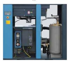
Оптимизация системы охлаждения (теплообменник, маслобак, вентилятор) компрессора позволяет увеличить ресурс его работы.
