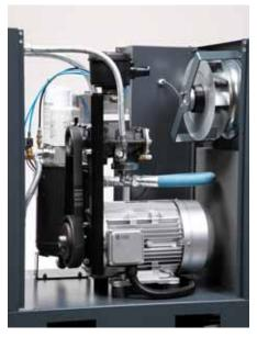
• Компрессоры LB штатно оснащаются центробежными вентиляторами, которые имеют пониженный уровень шума и меньшую скорость вращения. По сравнению с осевыми центробежный принцип обеспечивает равномерное давление по всему диаметру воздушного потока, что гарантирует эффективное охлаждение.
