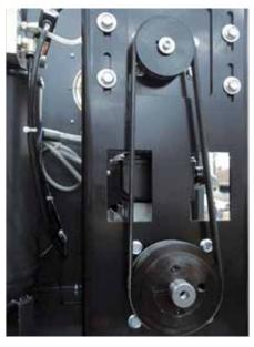
• Надежный и простой в эксплуатации традиционный ременной привод. Способен работать в самых жестких условиях при максимальной нагрузке. Простота конструкции обеспечивает легкость регулировки и замены ремня.
